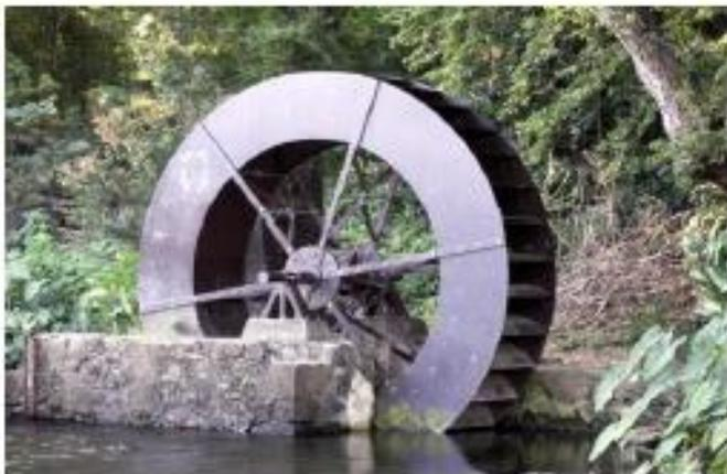
Le moulin à eau utilise la force motrice de l'eau : l'eau fait tourner la roue qui entraîne des engrenages pouvant actionner une meule ou une presse.
