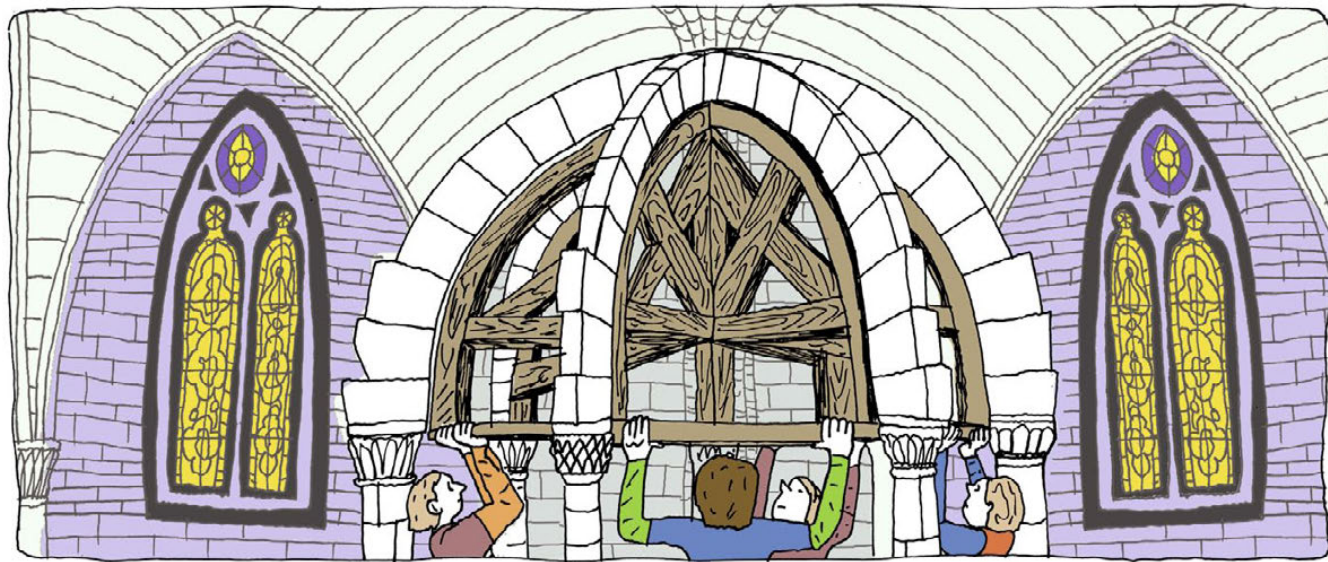
On s'apprête à enlever les planches qui ont permis de construire les voûtes. Les pierres qui ont été assemblées en suivant cette forme vont maintenant tenir toutes seules !
